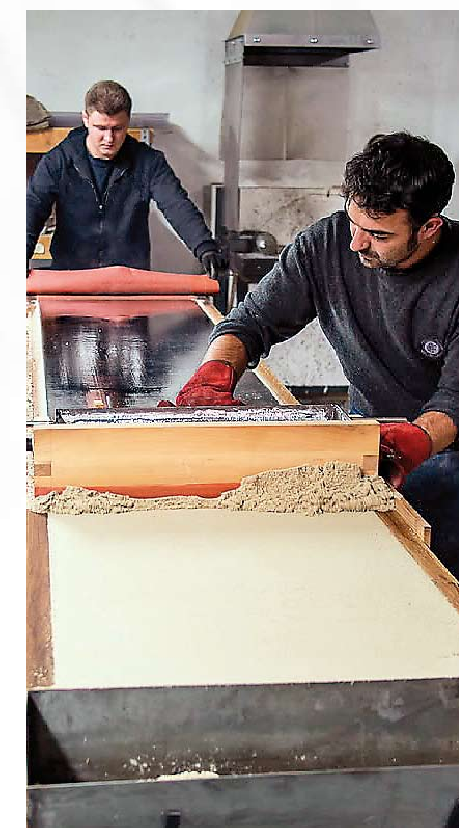
Výroba prospektových píšťal pro litické varhany litím cínu do pískového lože (varhanářská dílna v Itálii).
